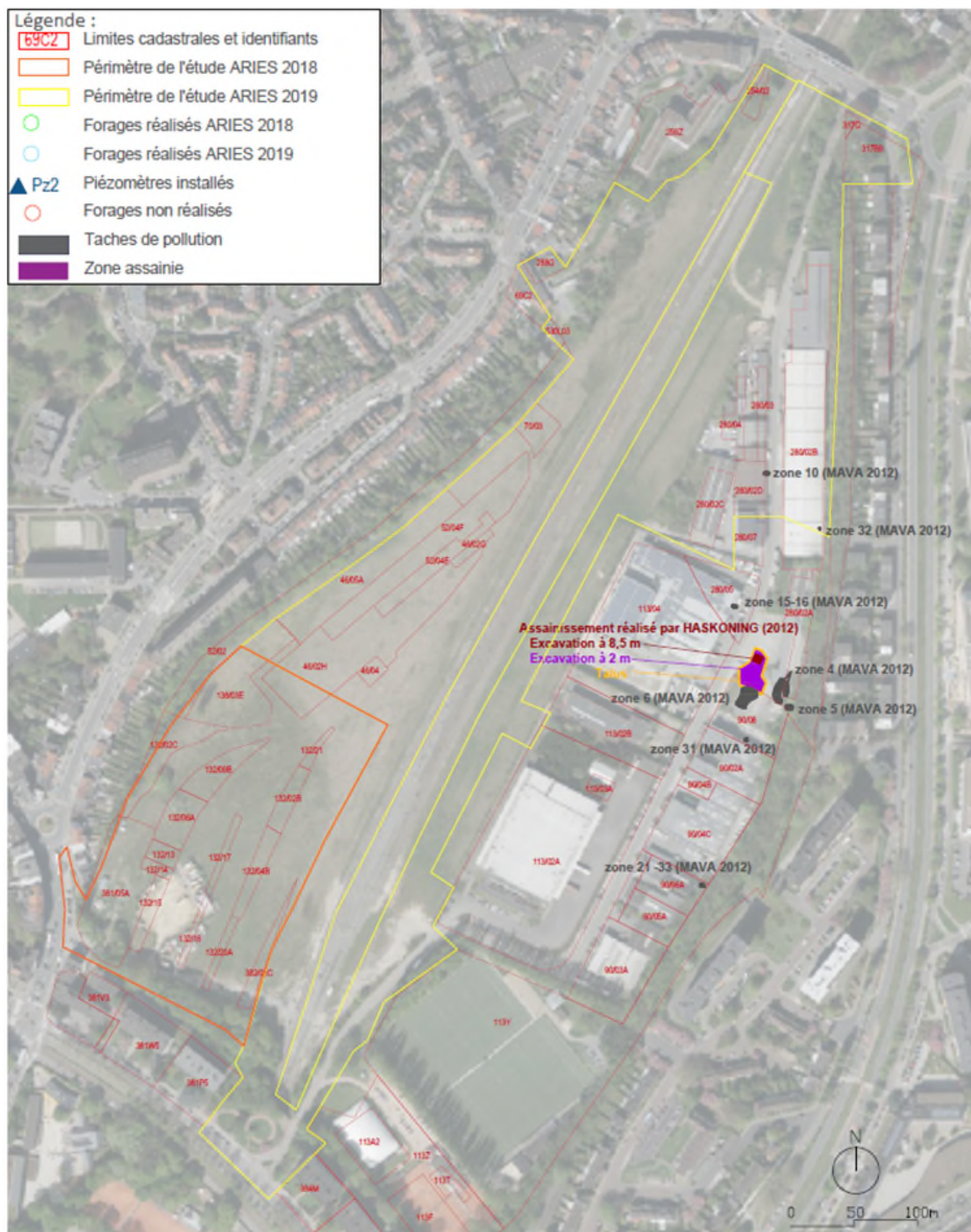
Figure 117 : Localisation des taches de pollution constatées au niveau de la ZIU (ARIES, 2021 sur base des RnT des études de sol disponibles)
