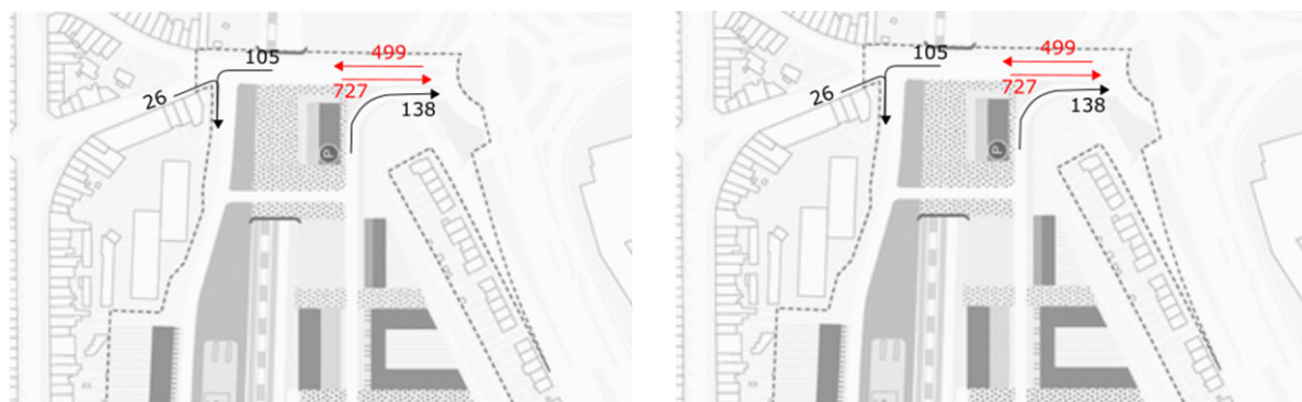
Figure 33 : Flux prévisibles à l'accès "Pont de Boeck" en pointe du matin (en noir = flux prévisible du site ; en rouge flux existants Données comptages ARIES Septembre 2016 ) ; sans (à gauche) et avec (à droite) réaménagement du Pont De Boeck (ARIES, 2021)
